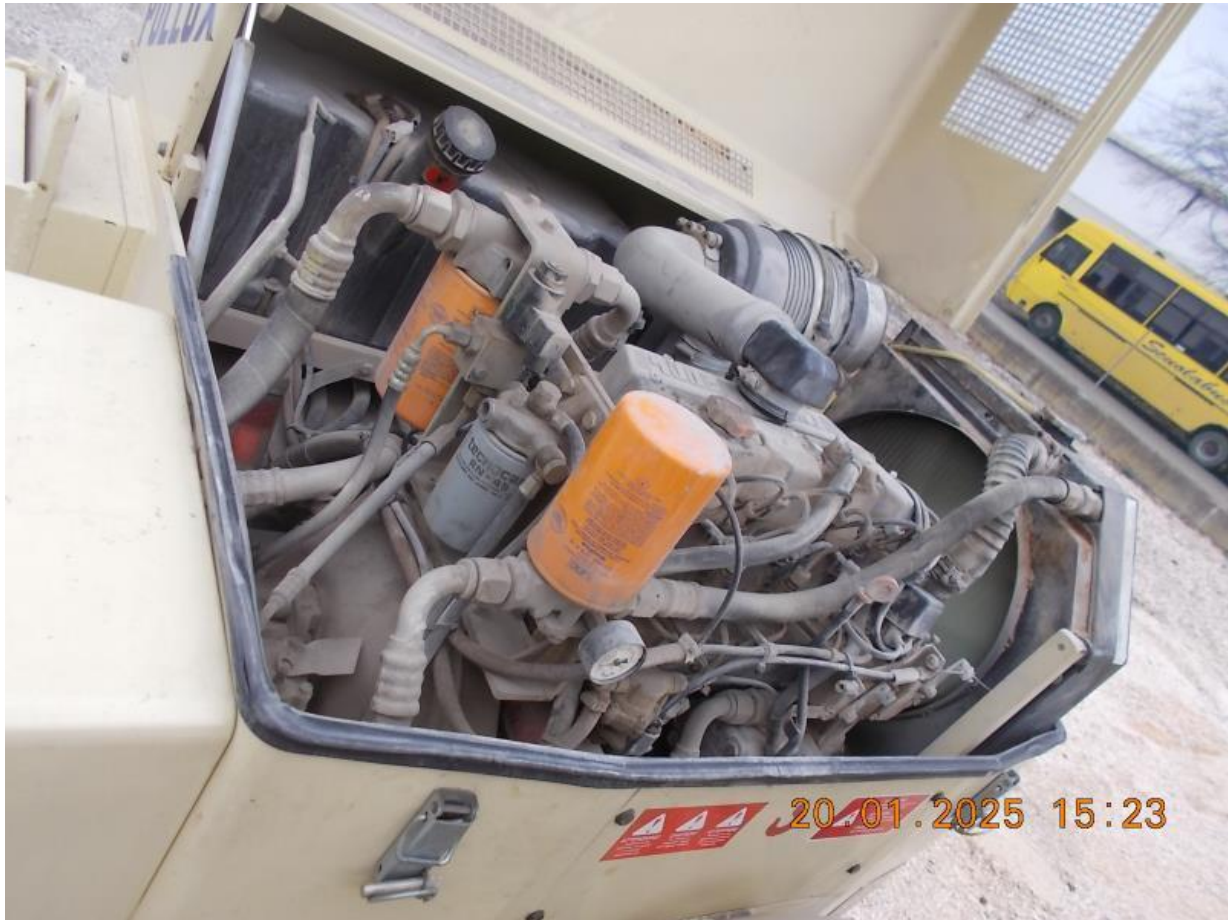
assenza di trasudazioni e perdite di liquidi del motopropulsore
