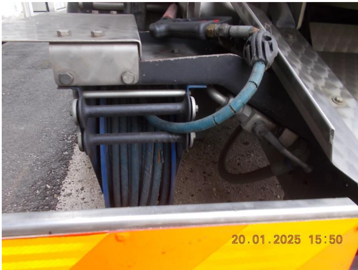
precario stato del rivestimento esterno della gomma del naspo ad alta pressione
